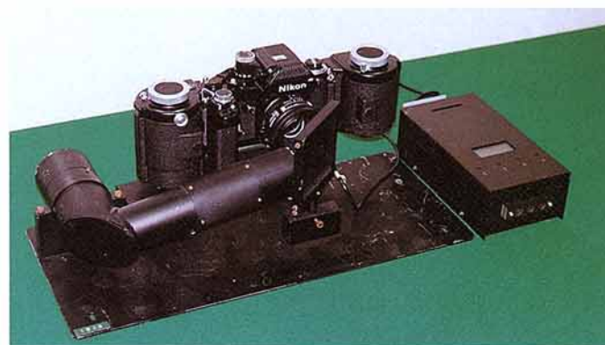
第4図 雷撃自動撮影カメラ構成図
