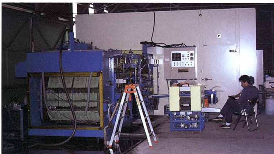
第2図 ヒートポンプ利用ノリ乾燥機の外観
