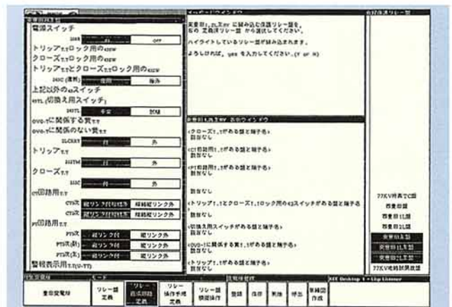
第4図 模擬操作盤作成機能（リレー盤）
