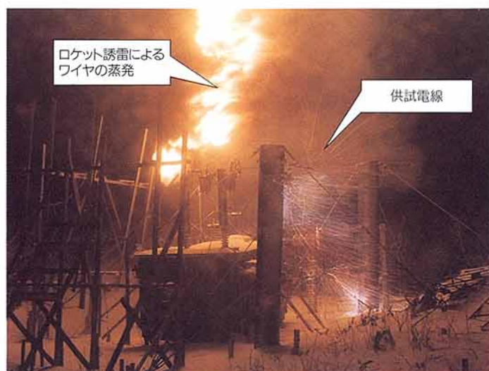
第1図 誘雷実験状況
