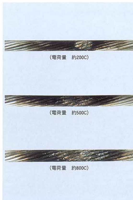
第6図 アーク試験による損傷状況（タイプ5）
