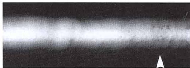
第1図 溶接欠陥のX線フィルム（ブローホールの例）
