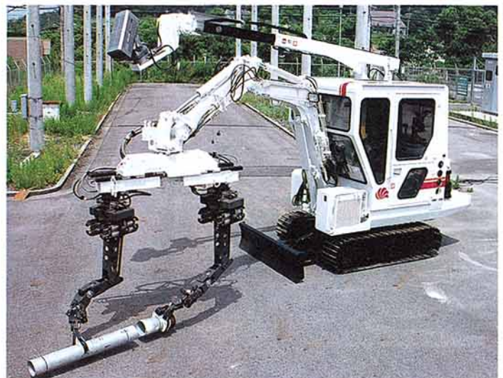
第4図 電力管理設ロボット
