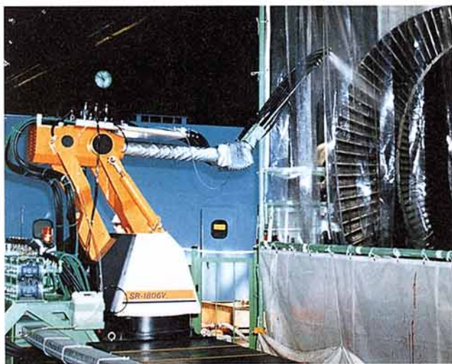
第7図 タービン翼検査ロボット
