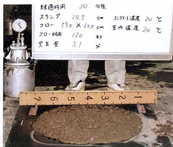
第1図 スランプフロー測定
