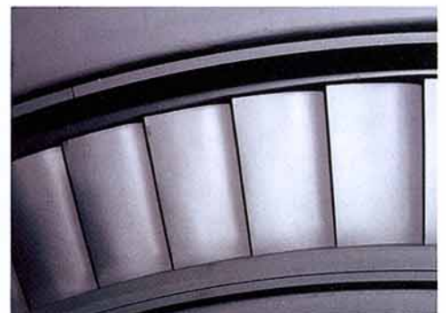
第3図 試験後の溶射ノズルの状況
