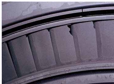
第2図 試験後の従来ノズルの状況
