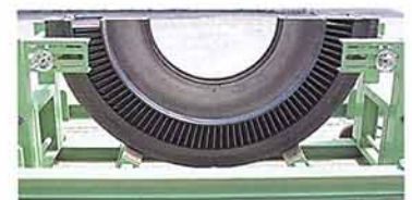
写真-5 清掃後の静翼の状況
