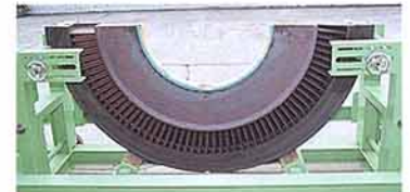
写真-4 清掃前の静翼の状況
