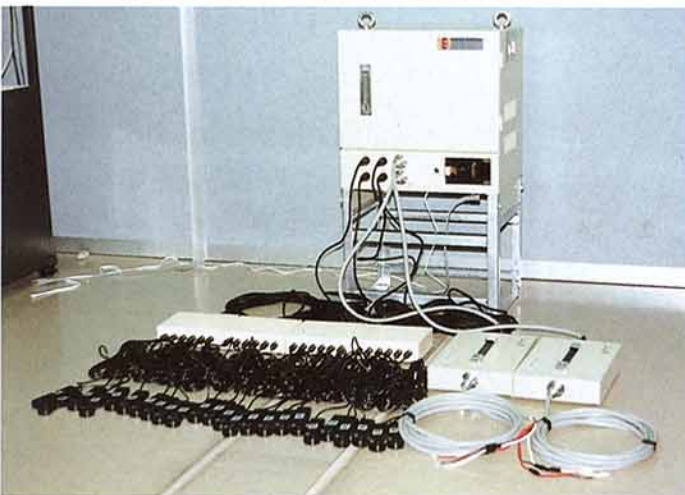
第3図 変電所用子局とセンサー
