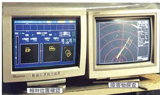
第2図 航路探査システムの監視画面
