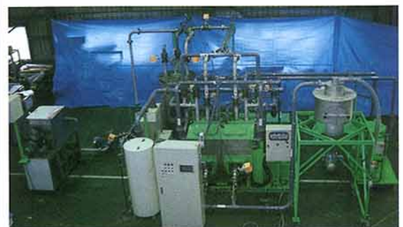
試作した廃魚処理機
