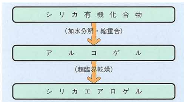
第3図 透明断熱材の作製方法
