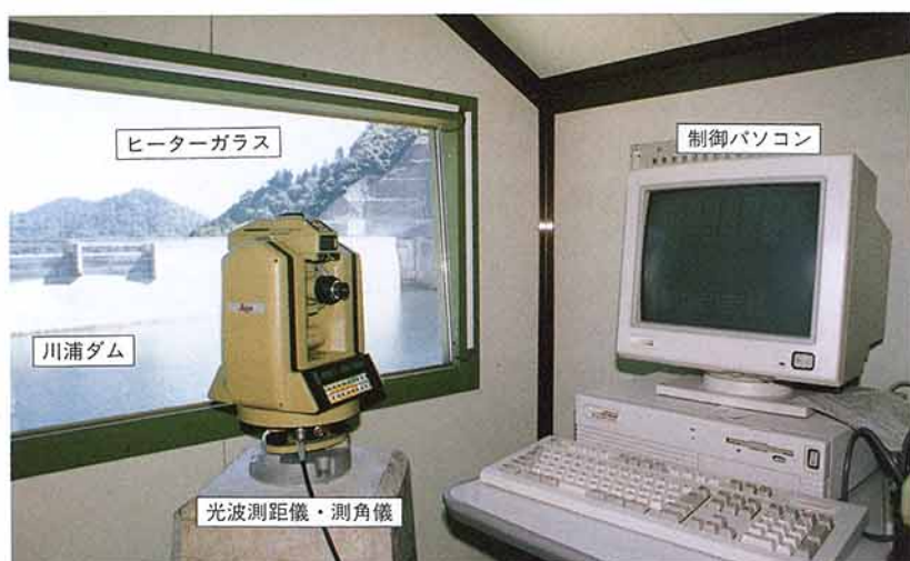
第2図 観測小屋内部からの風景 右横が制御パソコン、正面が光波測距儀・測角儀およびヒーターガラス（ヒーターガラスの向こうに川浦ダムが見える）
