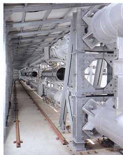
第6図 長期課電試験（試験線路）
