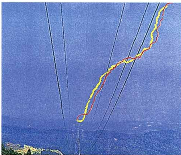
第2図 架空地線への多重雷撃 (二つの雷撃と風景を重ね画像処理)
