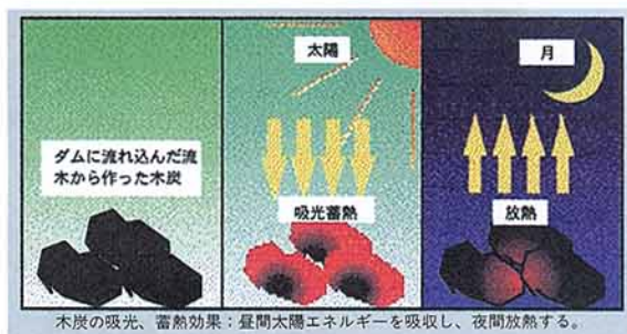
第1図: 木炭の吸光・蓄熱効果を示すモデル図
