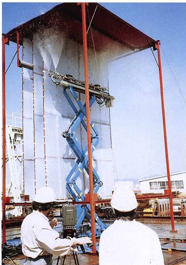
第1図 ロボットによる模洗浄状況
