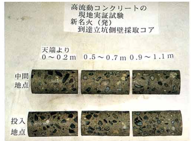
第5図 立坑採取コア(側壁)
