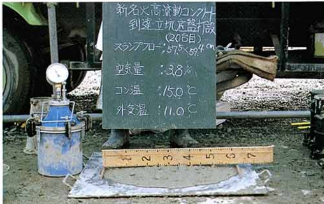
第3図 空気量・スランプフロー測定
