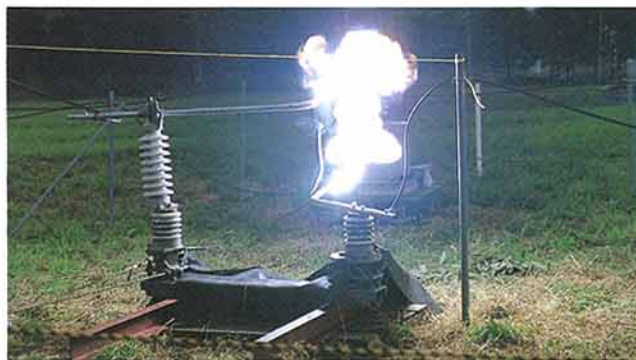
第1図 人工地絡試験
