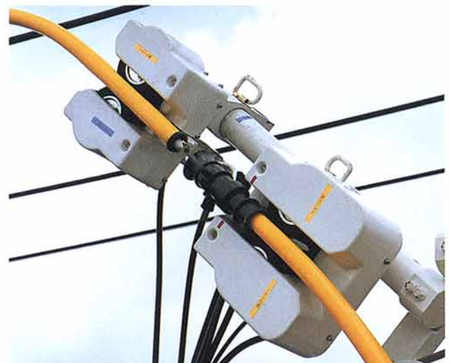
第4図 ポリ管相互の自動着脱機構
