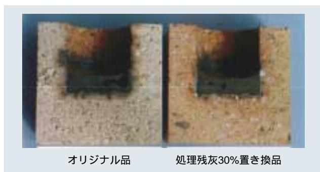
第3図 溶融炉スラグ浸食試験結果
