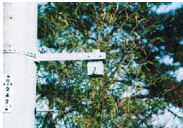
第2図 ガラス線量計取付写真
