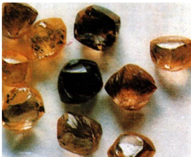
第2図 静圧合成法によるダイヤモンド  $100\mu\text{m}$
