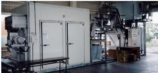
第2図 氷充填システムの外観
