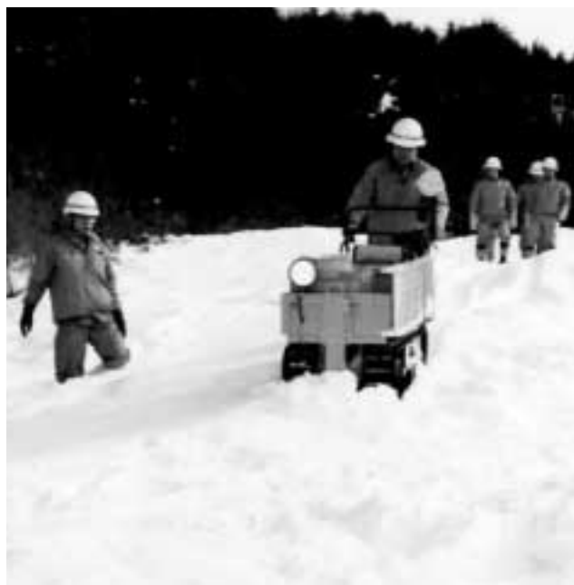
第1図 雪上用小型運搬車による資機材運搬風景
