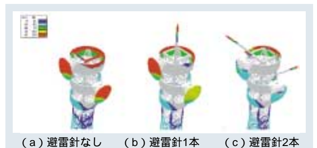
第4図 避雷針の追加配置による保護範囲の変化
