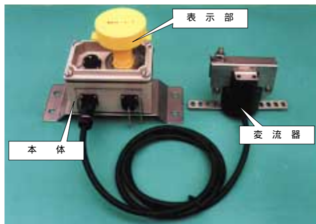
第4図 シース電流検出型故障区間検出装置の外観
