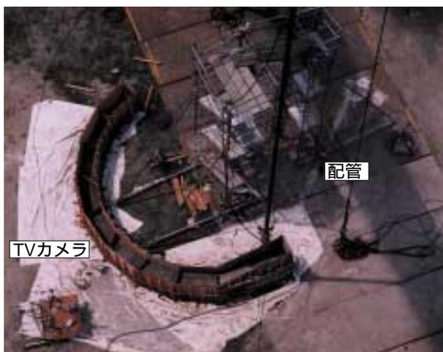
第3図 型枠内流動試験状況
