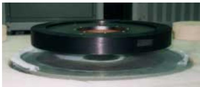
第3図 超電導スラスト軸受け
