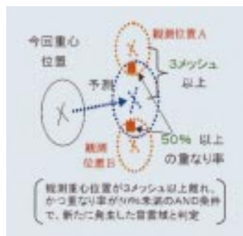
第3図 雷域追尾方式の概念図
