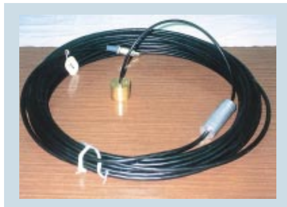
写真3 ケーブル（信号線）に接続されたAEセンサーとプリ・アンプ
