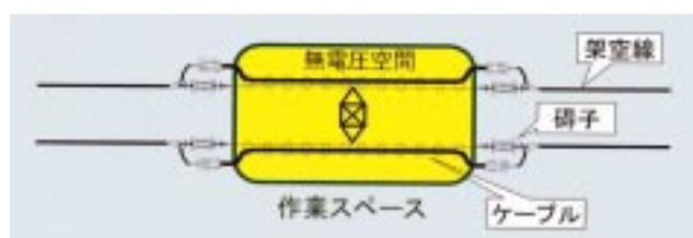
第1図 ケーブルジャンパ工法
