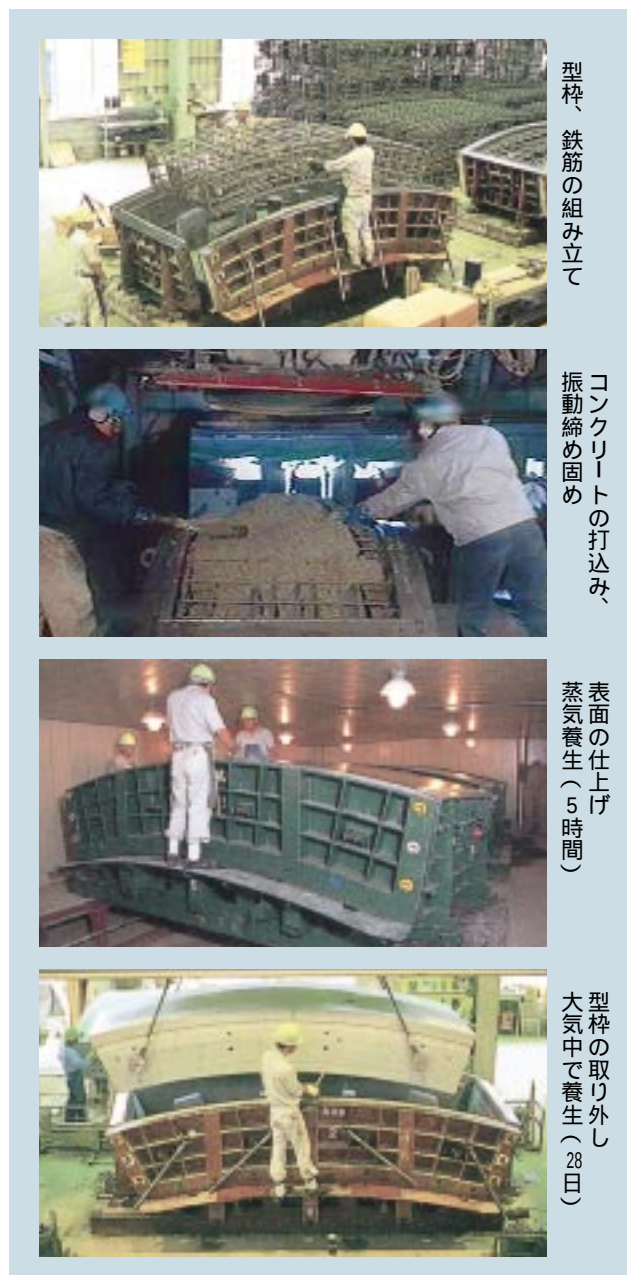
第2図 セグメントの各製造工程
