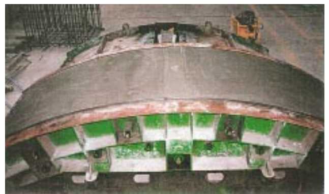
第5図 型枠取外し後のコンクリート表面
