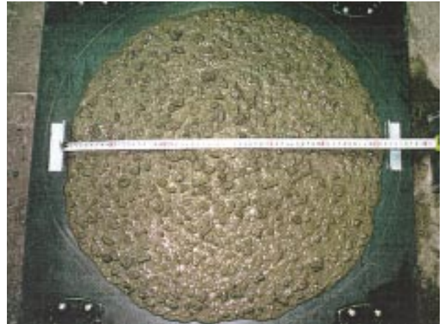
第3図 フライアッシュを用いた高流動コンクリート
