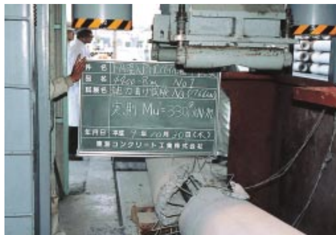
第3図 軸力曲げ試験状況（PHC杭、φ400）
