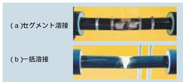
第2図 導体溶接部
