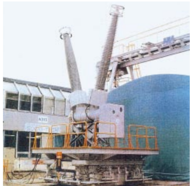
第3図 耐震試験状況
