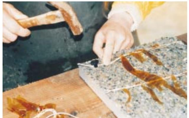
写真3 種糸の取り付け状況
