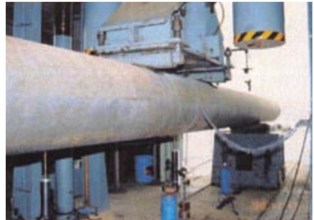
第4図 杭の曲げ試験
