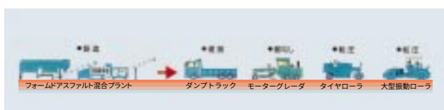
第4図 施工フロー
