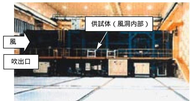
第3図 大型低騒音風洞試験設備
