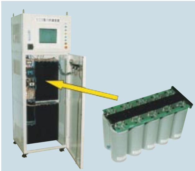
第2図 電力貯蔵装置縮小モデルの外観
