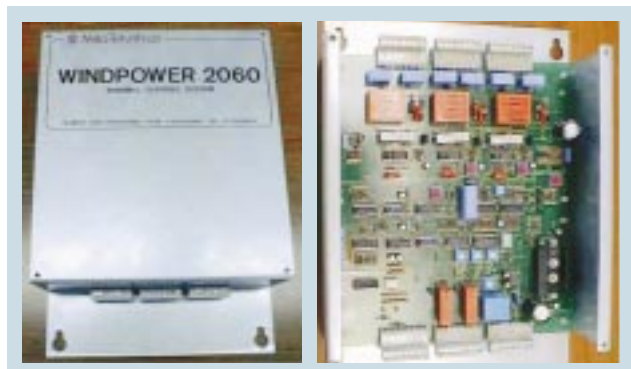
第1図 緩電流投入装置（制御装置）
