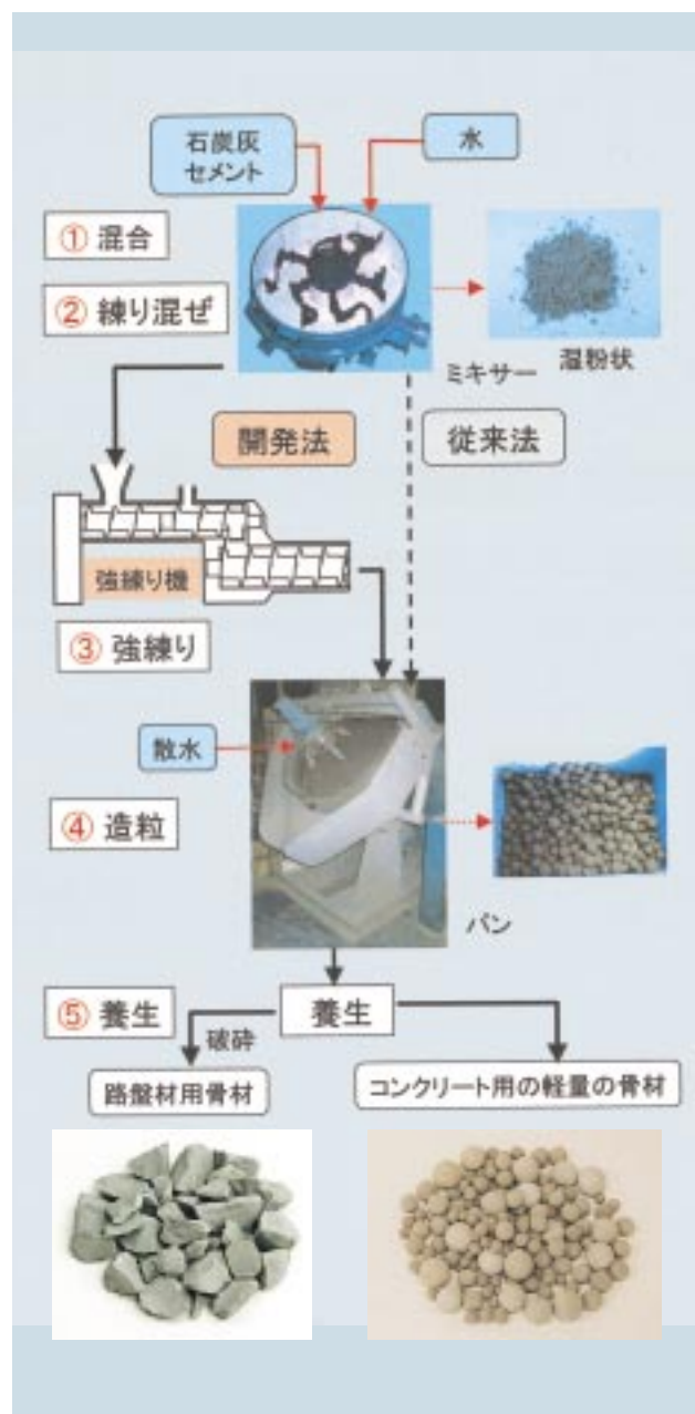
第1図 石炭灰質人工骨材の製造方法
