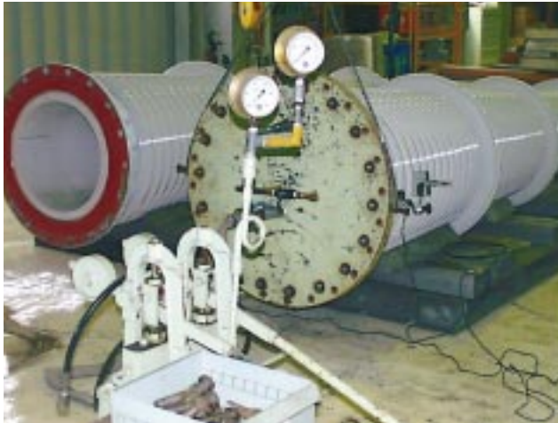
第1図 内圧耐荷重試験状況
