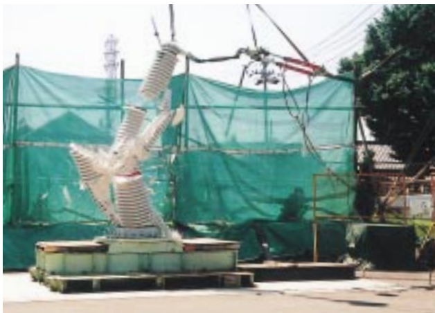
第2図 曲げ破壊試験状況(破断した瞬間)
