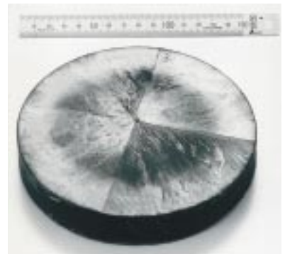
世界最大の超電導バルク体(直径15cm)
