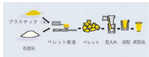
第13図 石炭灰混合プラスチック製品の作成方法
