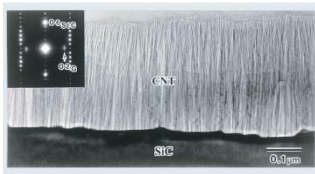
第12図 SiCを真空中で高温に加熱することによって形成した高配向カーボンナノチューブ
