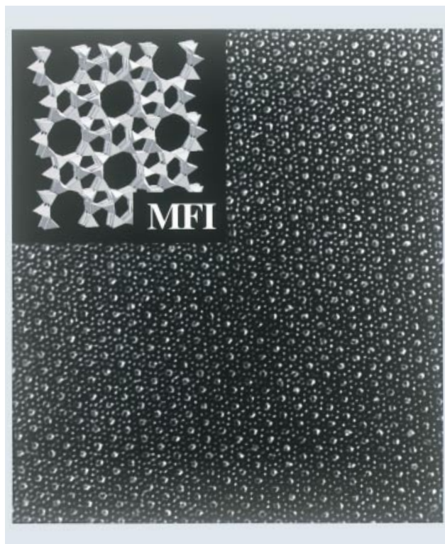
第11図 低電子線照射法により撮影したゼオライト (MFI) の高分解能像
