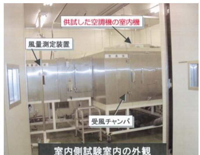
第3図 小型空調試験装置の外観
