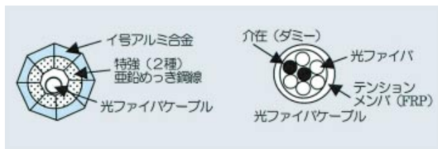
第1図 開発当初のOPGW 5心・外周テンションメンバタイプ例
